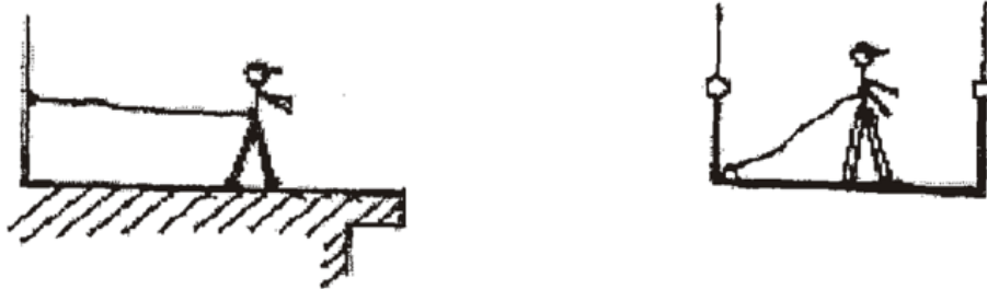
caduta totalmente trattenuta - caduta impossibile
